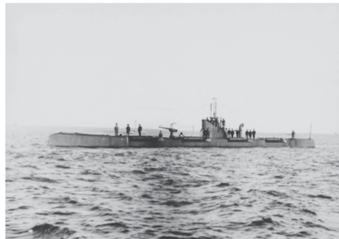
Подводная лодка «Кугуар». Построены 16 ед. типа «Барс» на заводах Петрограда и Ревеля по проекту И.Г. Бубнова. В 1915 – 1917 гг. приняли активное участие в боевых действиях на Балтике. Их главной задачей стал срыв вывоза железной руды из Швеции в Германию. Подводная лодка этого типа «Пантера» в августе 1919 г. потопила в Финском заливе эсминец «Виттория» английских интервентов
